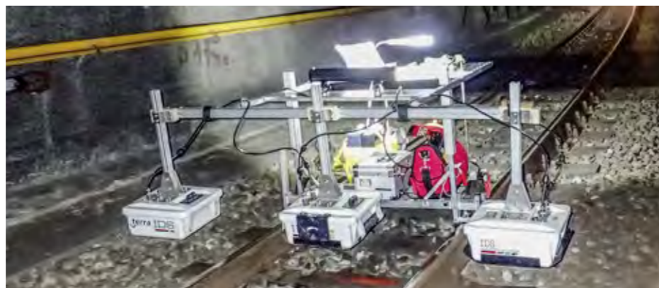
Bild rechts: Auch in neu ausgebrochenen Tunnelröhren sind zahllose Messungen vorzunehmen, wie hier mit einer mobilen Georadarausrüstung der Terra AG im Tunnel Lopper.
